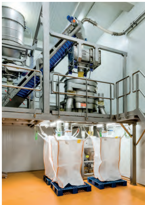
Afb. 2 De grofste korrelfractie wordt via een ontvangstvat (rechtsachter de big bags) via een tweede pneumatische transportlijn weer naar het ontvangststation (linksboven) teruggevoerd.
