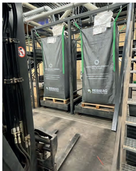
Afb. 8 Big bags met schoon en stofvrij polypropyleen maalgood.
