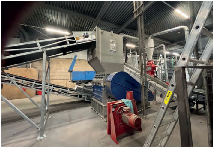
Afb. 6 De AMIS messenmolen verkleint materiaal tot circa 12 mm.
