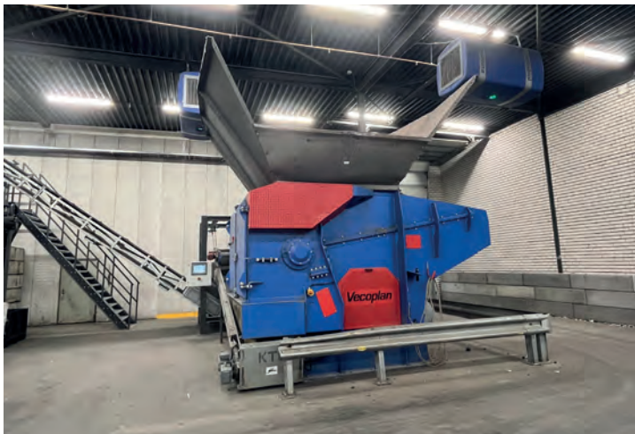
Afb. 5 De Vecoplan shredder verkleint materiaal tot circa 80 mm.
